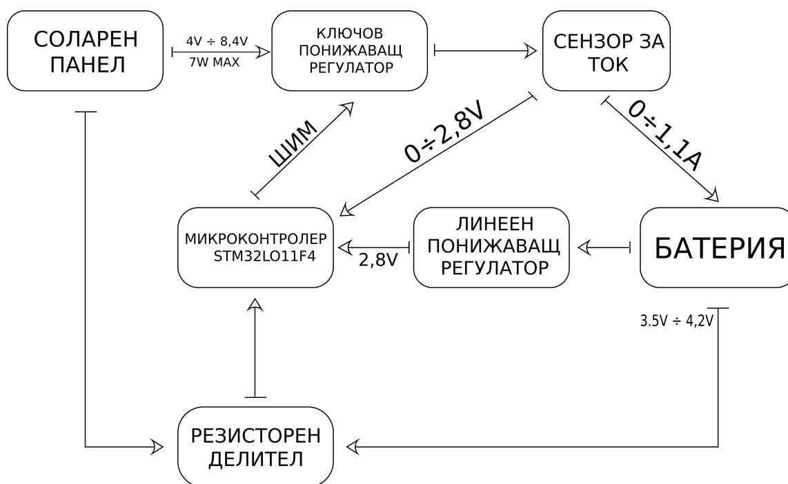
Фигура 6: Блокова схема на захранването
